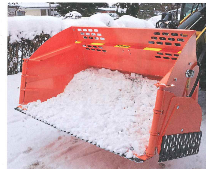
FMG HYBRID -kauhojen tilavuudet ovat yhdestä kuutiosta aina 6,5 kuutiioon. Höylätyn polanteen saa nostettua suoraan kasalle.
